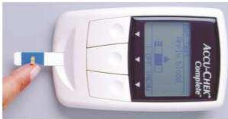
Figure 14: capteur de glucose portatif [33]
