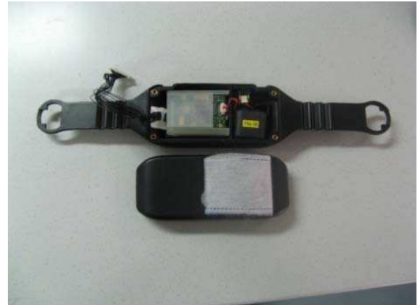
Figure 6: Coque semi-rigide (au-dessus) et boîtier amovible (en-dessous)
