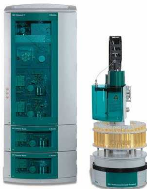
Figure 12: Chromatographe ionique Methrom ( http://www.metrohm.fr/chromatographie_ionique )
