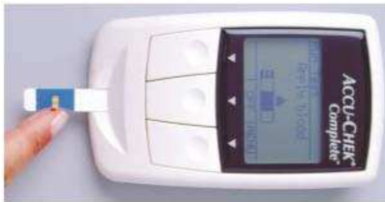
Figure 14: capteur de glucose portatif [33]
