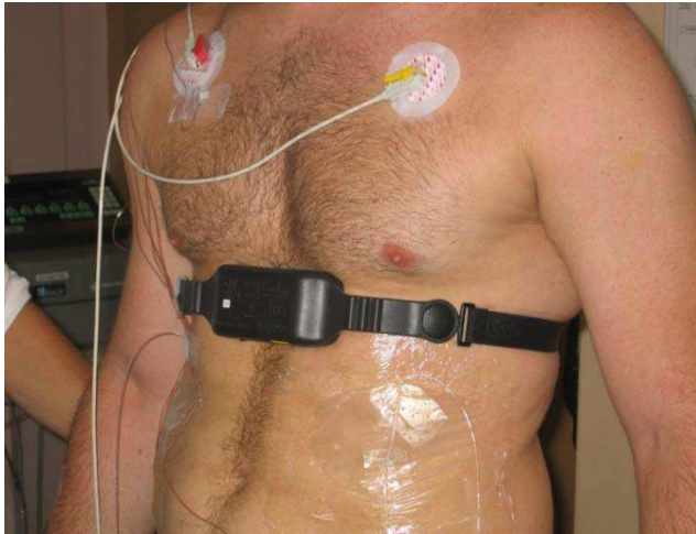
Figure 29: Photographie d'un sujet équipé d'un bandeau physiologique, de poches à sueur et d'électrodes
