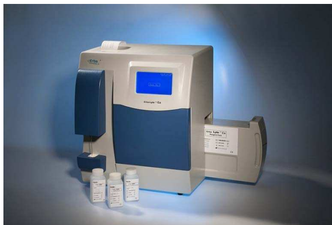
Figure 13: Analyseur d'électrolyte multi-paramétrique dédié aux fluides corporels ( https://www.lachema.com )
