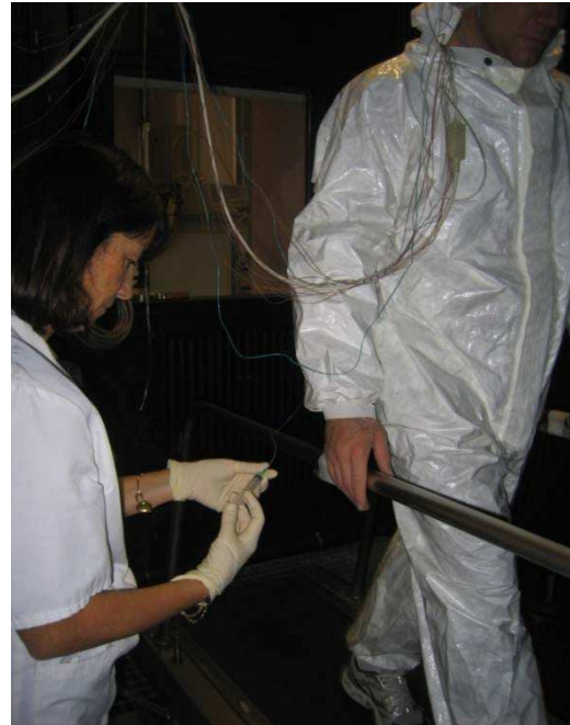
Figure 30: Prélèvements de sueur dans une des poches sur un sujet équipé d'une tenue étanche pendant l'exercice
