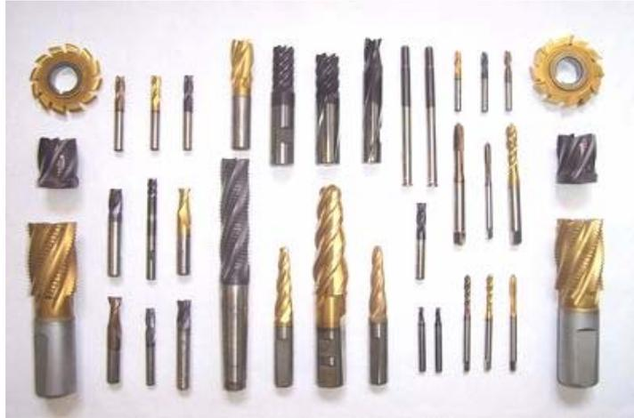
*Figure 5.1 : Exemples d'applications de dépôts de type CrN et TiN.*
