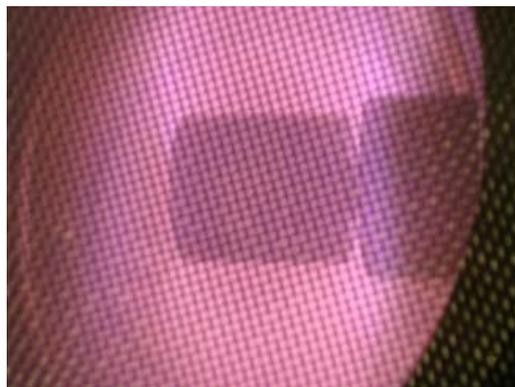
**Figure 2.13 :** Photo du plasma diffus créé par la seule zone de couplage RCE 2 dans le réacteur du LPSC (pression argon 2 mTorr, puissance micro-onde 100 W).
