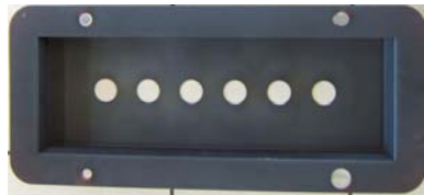
Figure 1.10 : Cliché de la tôle de protection de la paroi du réacteur.
