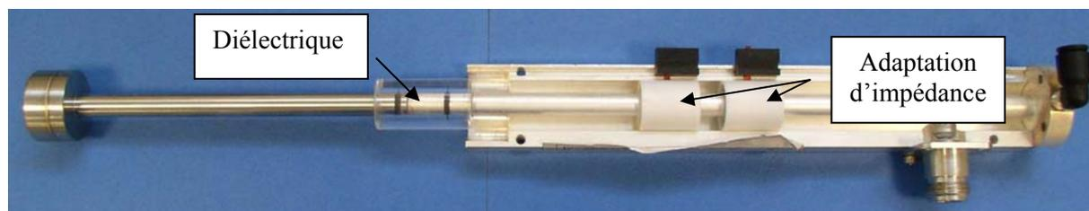
*Figure 1.2 : Cliché de l'intérieur d'un applicateur micro-onde.*
