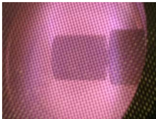
Figure 2.13 : Photo du plasma diffus créé par la seule zone de couplage RCE 2 dans le réacteur du LPSC (pression argon 2 mTorr, puissance micro-onde 100 W).
