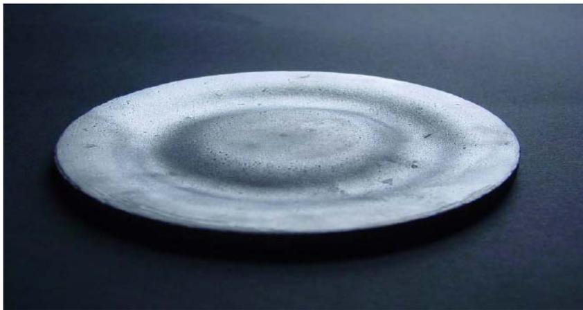
*Figure 5.5 : Photo montrant une usure non uniforme d'une cible utilisée dans une configuration magnétron circulaire.*
