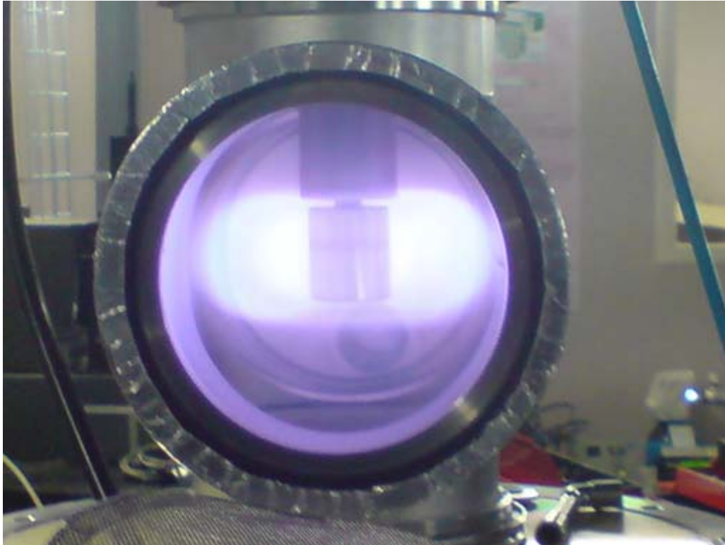
Figure 2.31 : Photo du plasma obtenu dans le réacteur du LPSC (pression argon 2 mTorr, puissance micro-onde 100 W).
