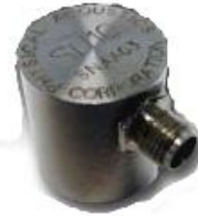
Figure 23 : Transducteur ultrasonore (Source Euro Physical Acoustics, type SH10).
