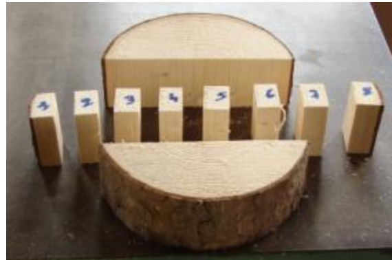
Figure 127 : Échantillonnage pour la détermination de la teneur en humidité (dimensions des échantillons: 2 \times 3 \times 5 \text{ cm}^3 ).
