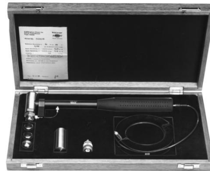
Figure 21 : Marteau instrumenté (Briel & Kjaer, type 8202).
