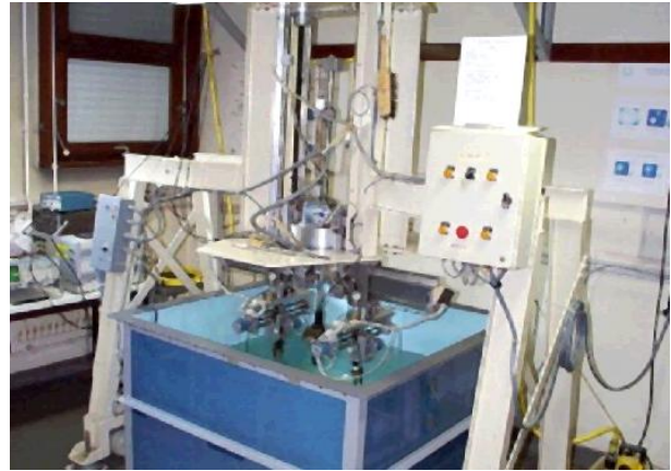
Figure 82 : Scanner à ultrasons (photo LMA).
