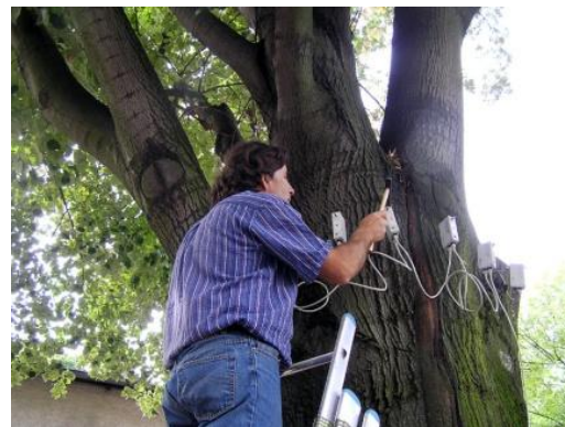
Figure 65 : Tomographe Arbotom ( http://www.rinntech.de/ ).
