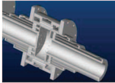
FIGURE 7.6: Schéma du TVC proposée par le laboratoire national d'énergie et de technologie (NETL) couplant une cavité et une zone pilote RQL [353].
