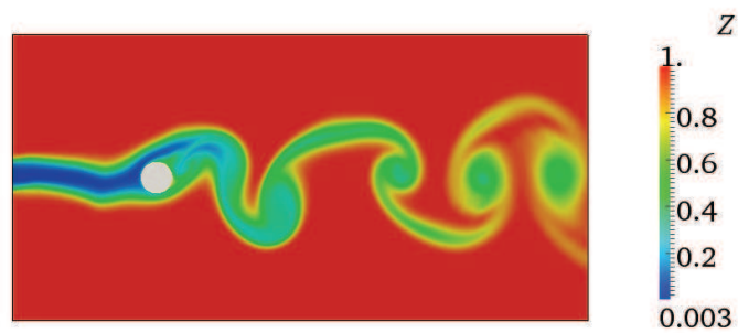
FIGURE 4.15: Carte instantanée du scalaire passif pour l'écoulement autour d'un cylindre circulaire avec Re_d = 300 obtenu avec le maillage M2 et des conditions de symétrie pour les plans en y .
