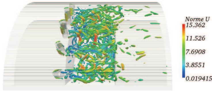
FIGURE 8.21: Contour d'un critère Q ( Q = 9.10^7 s^{-2} ) colorié par la norme de la vitesse 3D pour la configuration nominale.
