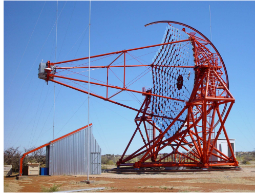
FIGURE 2.8 – Un télescope équipé de sa caméra et ses miroirs.
