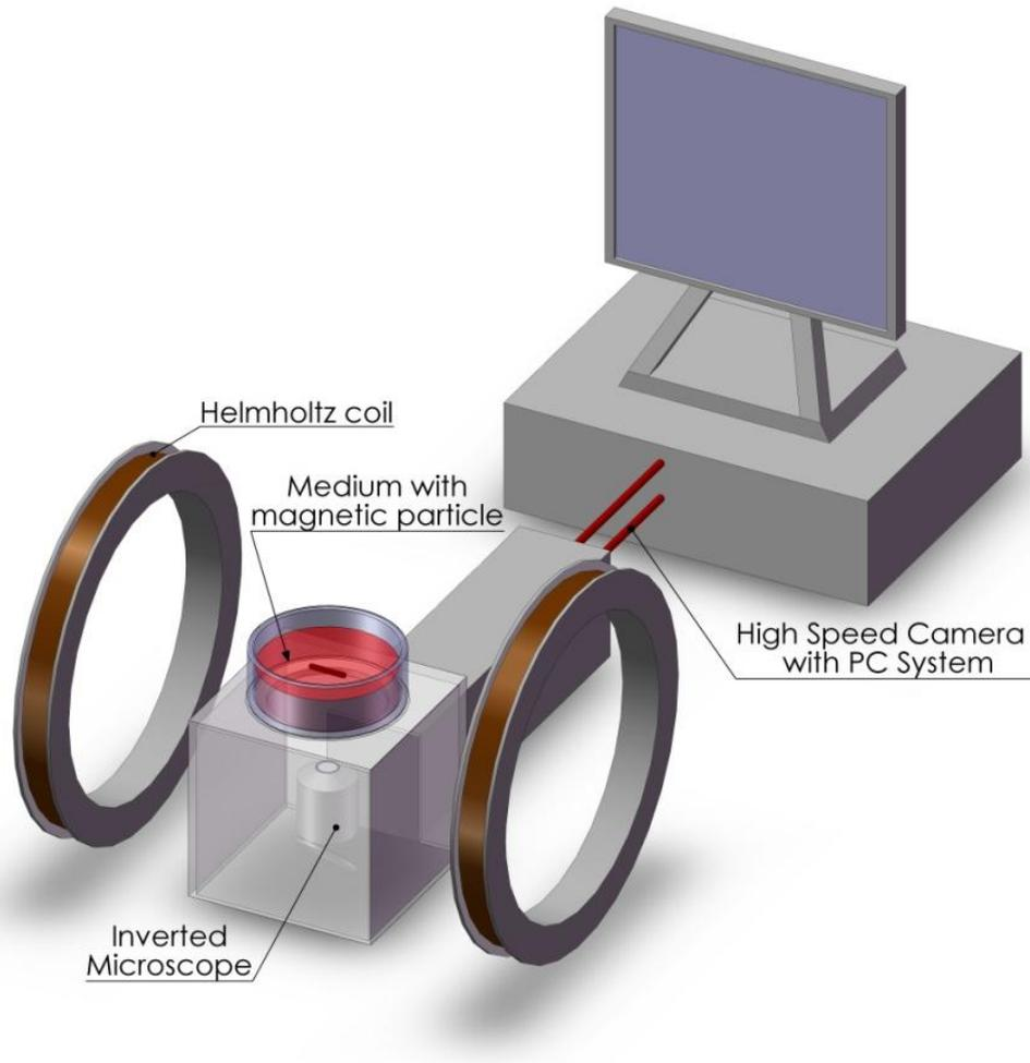
*Fig. 3-1 : Experimental setup*
