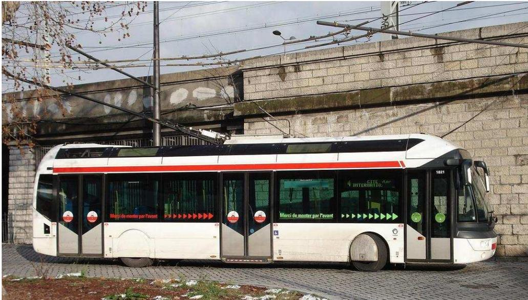
FIGURE 4.45 – Trolleybus Irisbus ETB12 avec ses perches déployées
