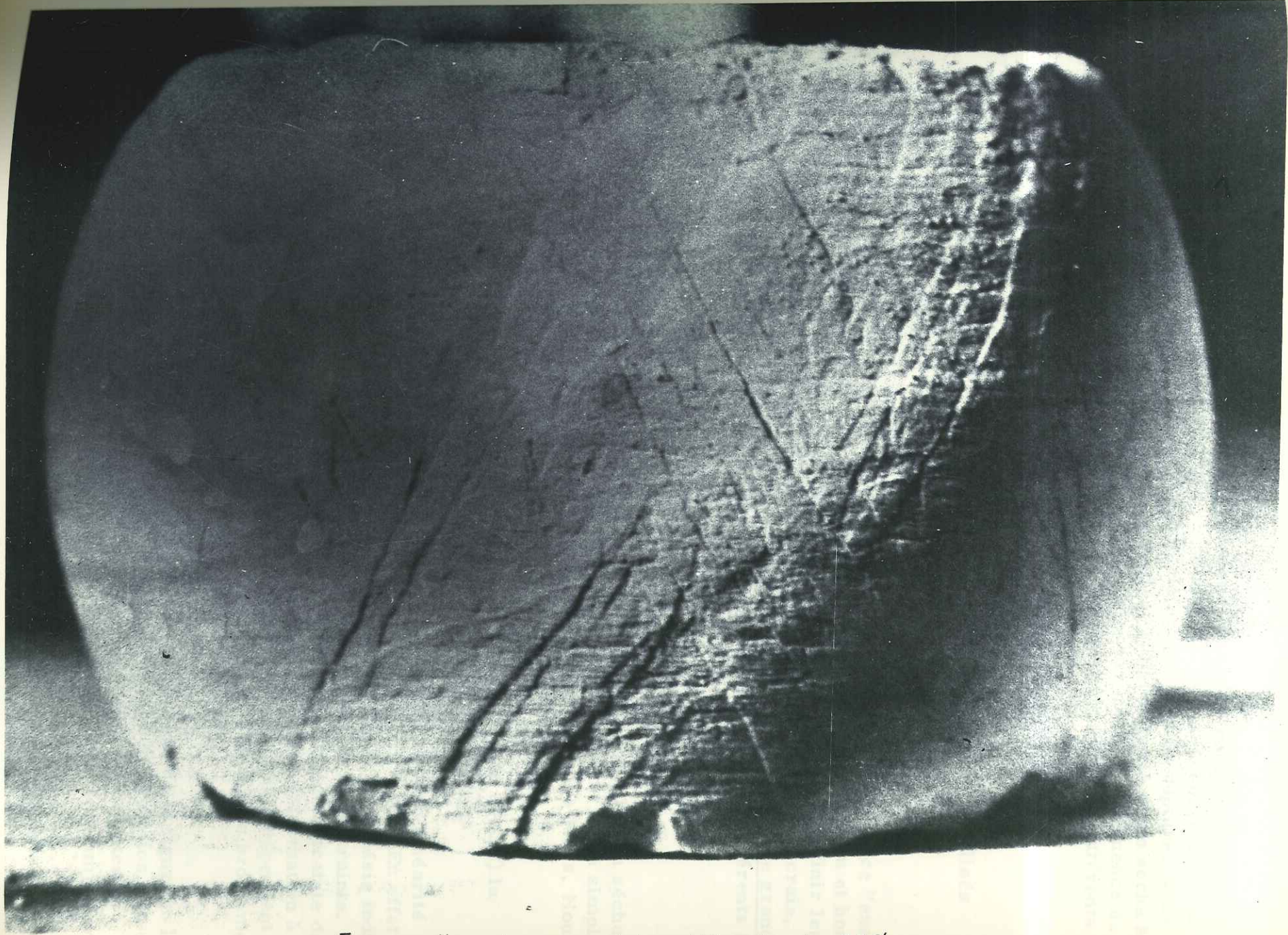
Eprouvette de craie sèche déformée de 55% Pression de confinement 200 bars
