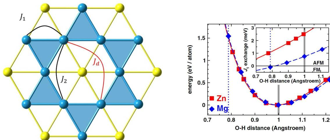
FIGURE 6.8 – Gauche : Définition des interactions d’échanges dans le plan kagome entre les premiers voisins  $J_1$ , les seconds voisins  $J_2$  ou selon la diagonale  $J_d$ . Droite : Dépendance des paramètres d’échanges selon la distance O–H, extrait de [178].
