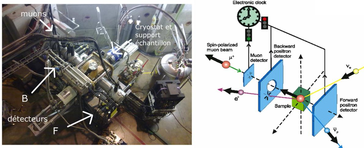
FIGURE 3.9 – Montage d'un dispositif de mesure de  $\mu$ SR sur la ligne de muons GPS au *Paul Scherrer Institut* (photo à gauche et schéma correspondant à droite). Les détecteurs de positrons disposés avant (B) et après (F) l'échantillon sont indiqués. Le schéma est extrait de [121].
