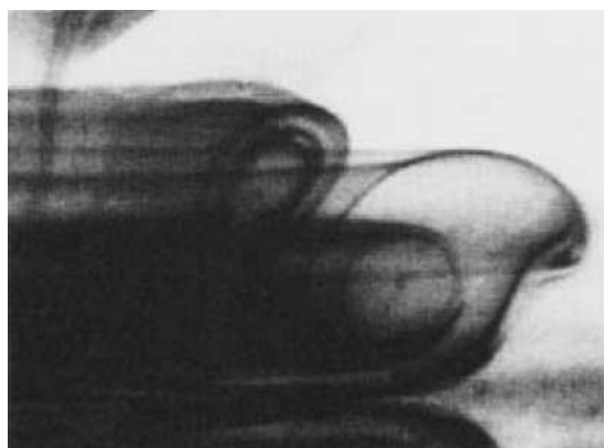
FIGURE 3.15 – Visualisation comparative de l'impact d'un vortex ring . À gauche : Visualisation expérimentale de Walker et al. [1987] avec Re_0 = 564 (quasiment équivalent à Re_\Gamma = 1306 ), obtenu avec l'insertion d'un colorant dans le vortex ring . À droite : Visualisation du champ d'entrophie Z = \omega_i \omega_i / 2 pour la simulation avec une paroi pénalisée. La création d'anneaux tourbillonnaires secondaires est bien visible sur les deux visualisations.
