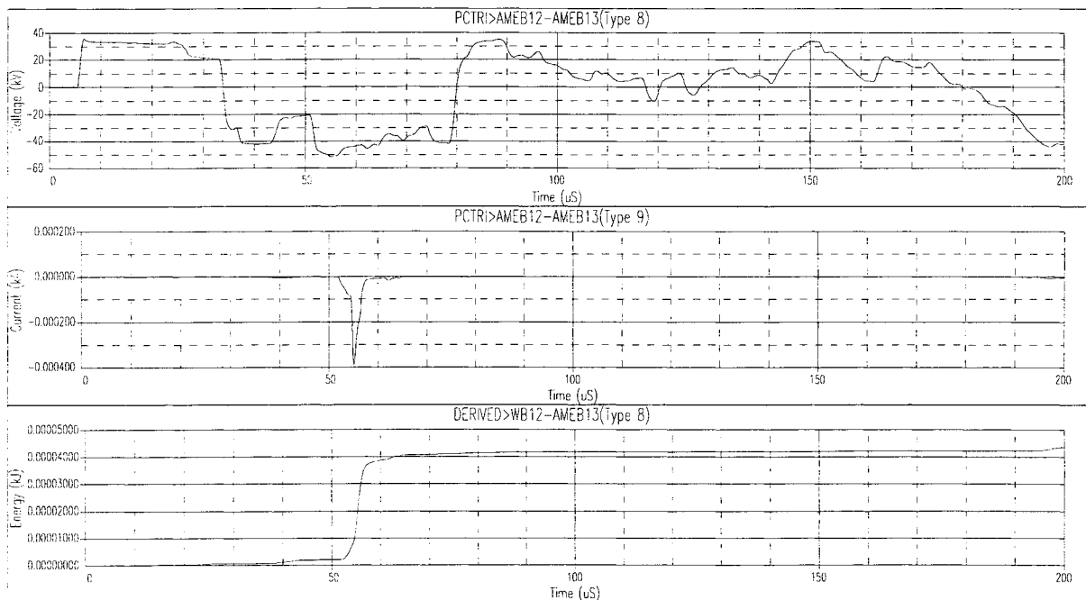
Parafoudres de gaine de la position B à la 1 ère jonction AE (Parafoudres de gaine montés en triangle. Foudroiement d'un conducteur de phase)
