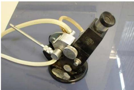
Figure II.4 Réfractomètre
