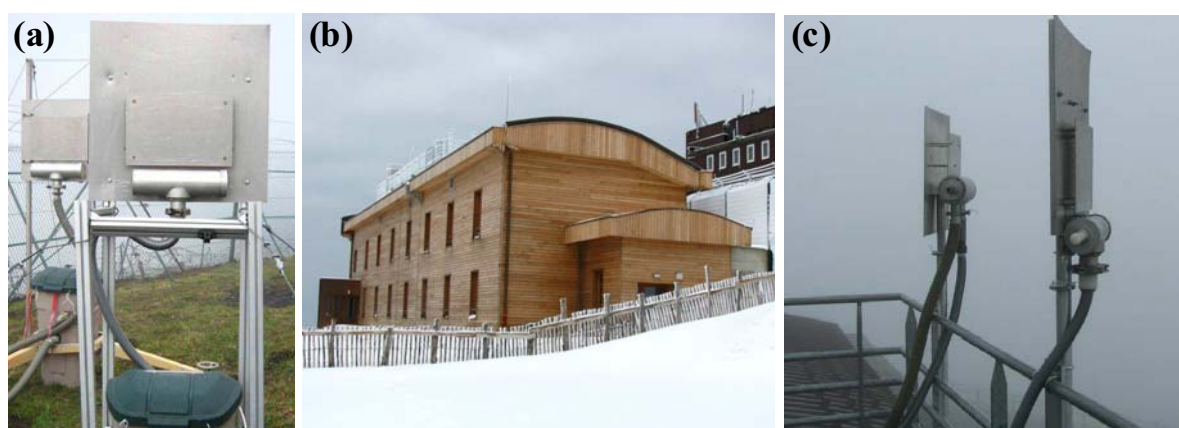
Figure II-4 : Aspirateurs à nuage sur leurs anciens (a) et nouveaux (c) emplacements de prélèvements à la station du puy de Dôme, (b) chalet scientifique du pdD après sa rénovation.
