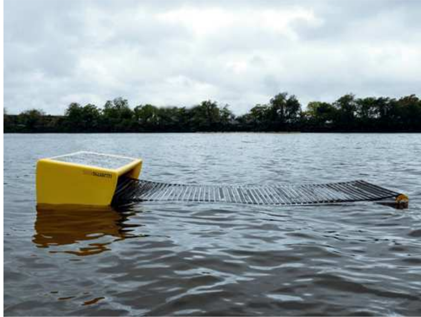
Figure 3 : Seaswarm, le robot nettoyeur de déchets pétroliers par Senseable de MIT
