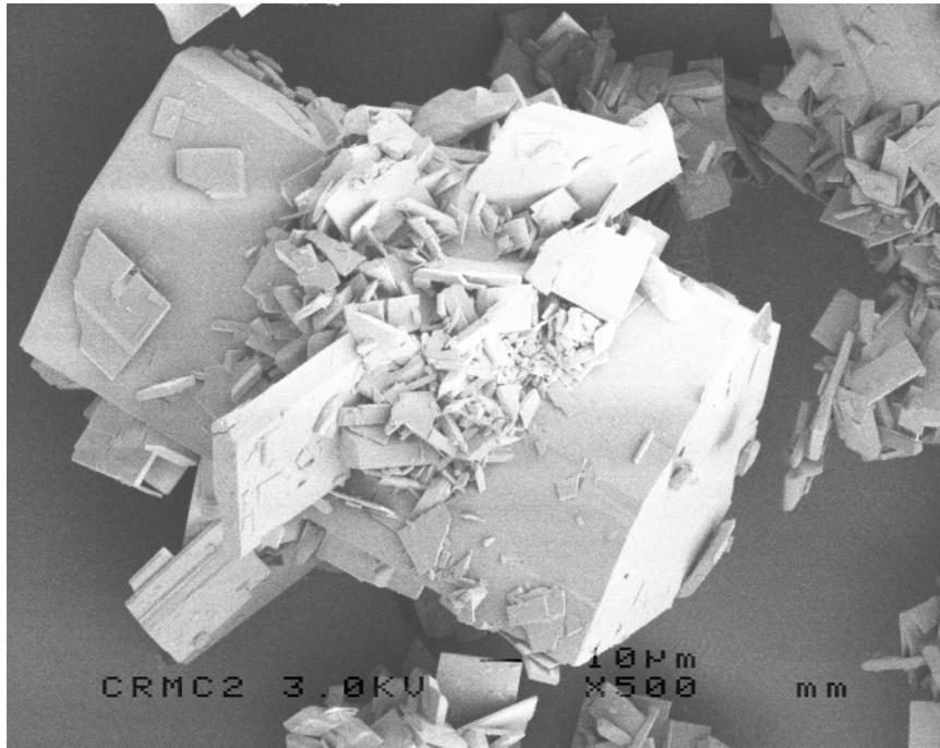
Photo MEB du faciès des cristaux en fin d'expérience dans le cas d'un ensemencement à l'extérieur de la zone de démixtion
