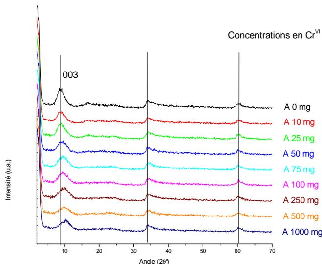
Figure IV-20 : Diffractogrammes X des composés boue-CrO<sub>4</sub> pour différentes concentrations initiales en chrome<sup>VI</sup>
