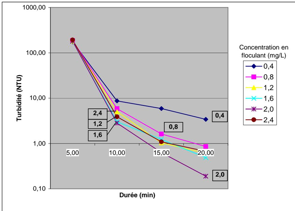
*Figure III-28 : Evolution de la turbidité en fonction du temps de décantation*
