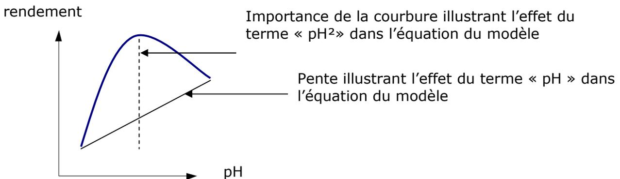
*Figure III-7 : Illustration de l'effet du pH et du  $\text{pH}^2$  sur les courbes de rendements de la précipitation, en fonction du pH*
