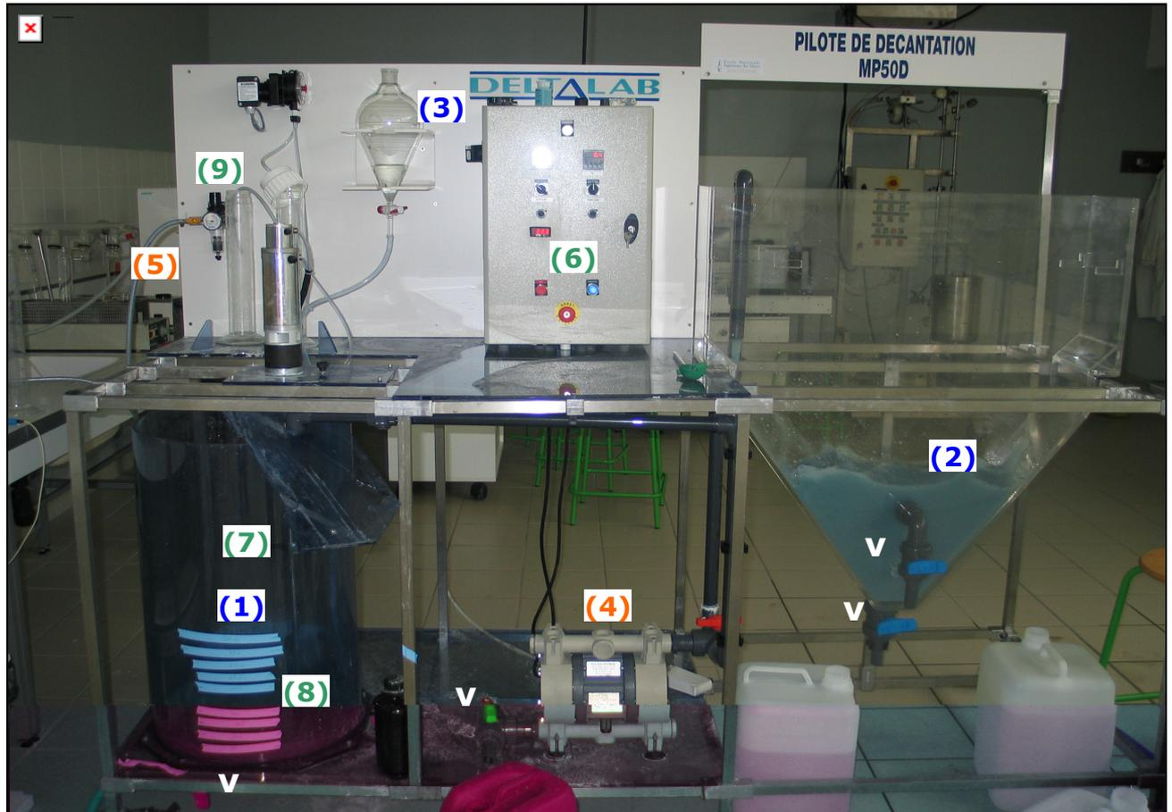
Figure III-20 : Le pilote de précipitation – photographie légendée
