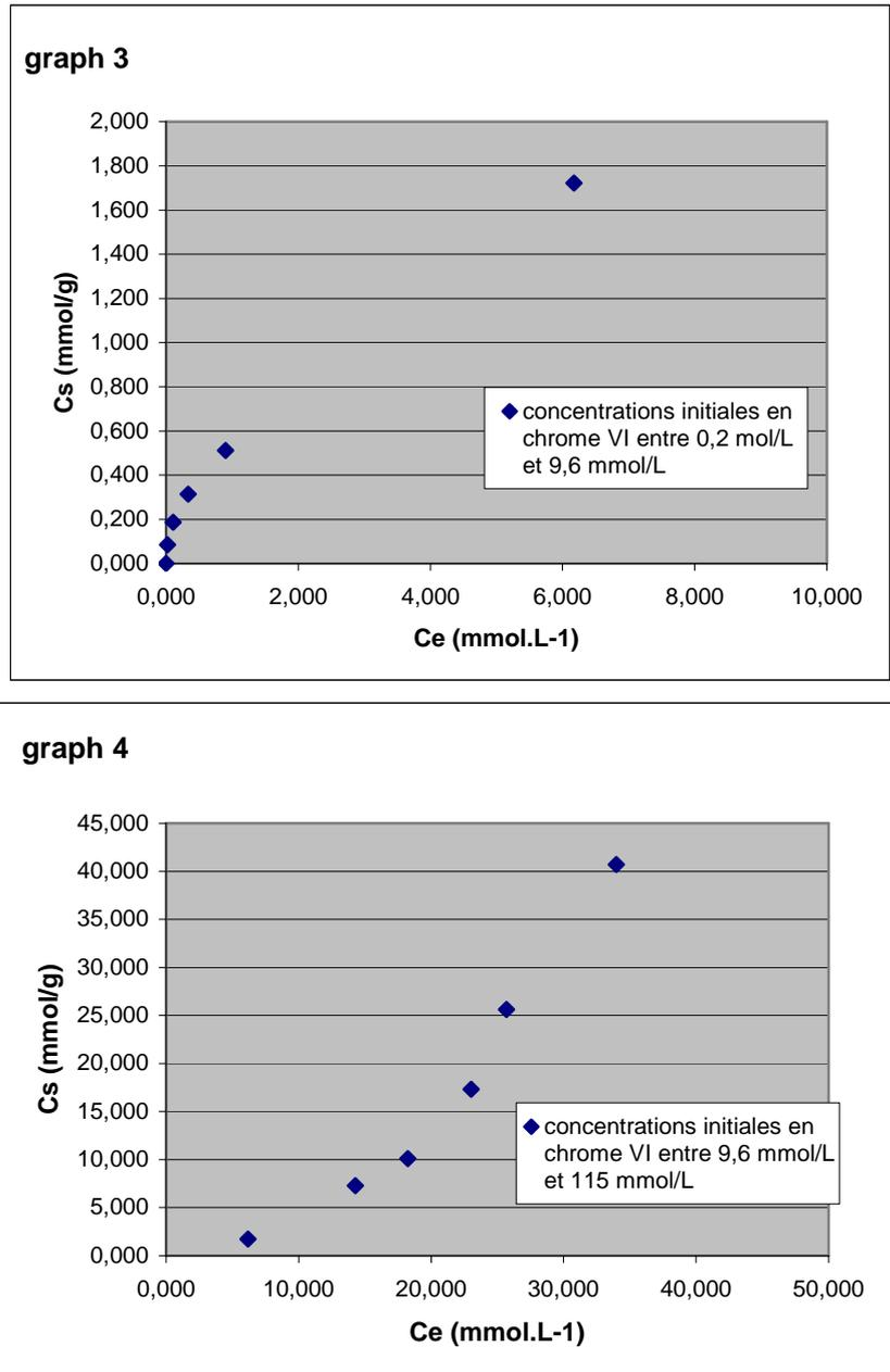
Figure IV-13 : Isothermes d'adsorption du chrome<sup>VI</sup> sous forme chromates sur [Zn-Ni-Al-SO<sub>4</sub>]
