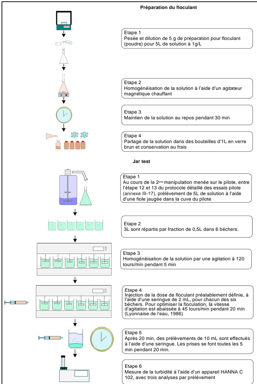
Figure III-26 : Synoptique du protocole des tests de floculation
