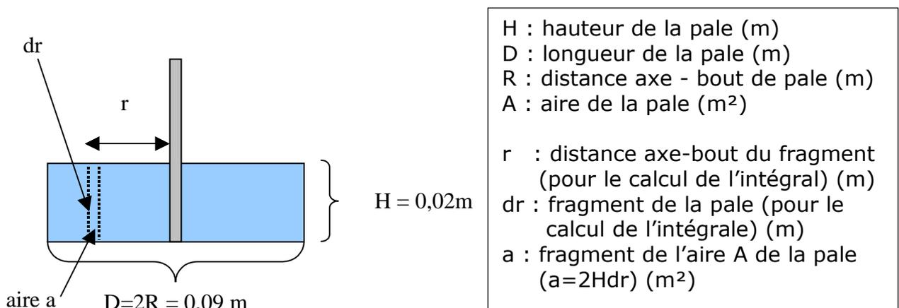
*Figure III-24 : Dimensions de la pale de l'agitateur*
