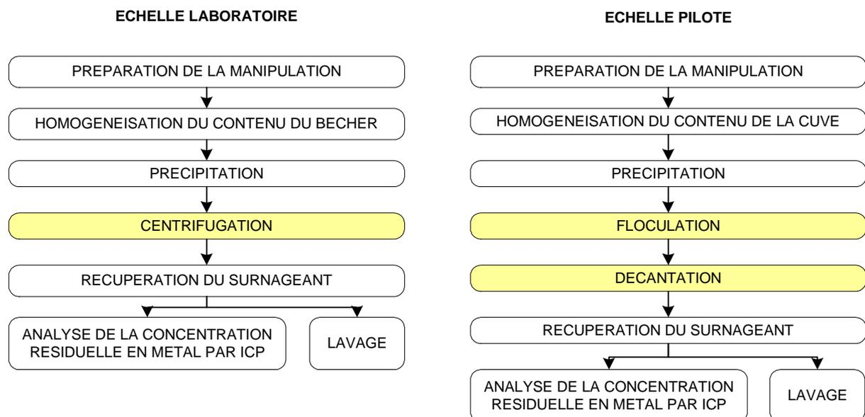
*Figure III-23 : Comparaison des protocoles utilisés aux échelles laboratoire et pilote*
