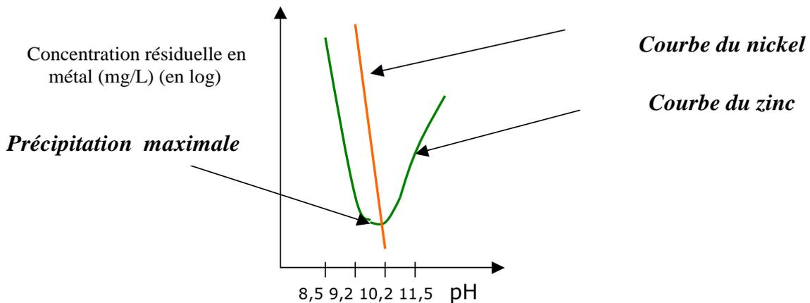
Figure I-12 : Courbes de précipitation pour le zinc ou le nickel en solution
