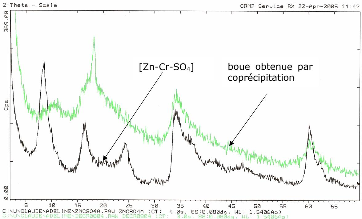
Figure IV-17 : Comparaison des diffractogrammes X de la boue obtenue par coprécipitation et d'un HDL [Zn-Cr-sulfates]
