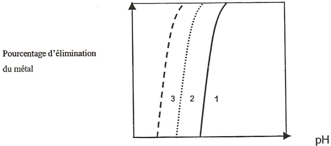
Figure I-13 : 1-précipitation, 2-adsorption, 3-coprécipitation [Crawford R. et al, 1993]
