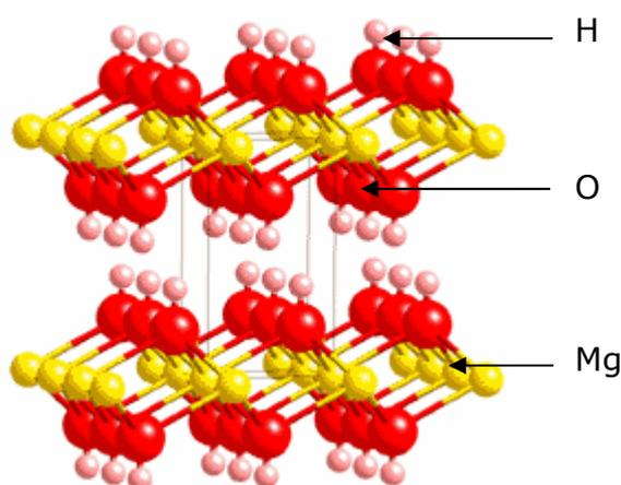
Figure I-18 : Structure de la brucite  $\text{Mg}(\text{OH})_2$
