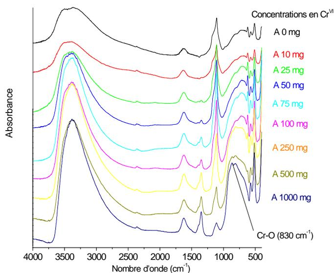
Figure IV-15 : Spectres IR des composés  $[\text{Zn-Ni-Cr}]\text{-CrO}_4$  pour différentes concentrations initiales en chrome<sup>VI</sup>
