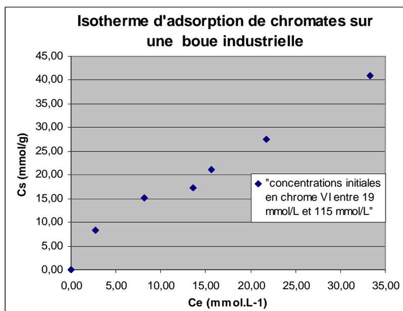
*Figure IV-14 : Isotherme d'adsorption de chrome<sup>VI</sup> sous forme chromates sur la boue industrielle*
