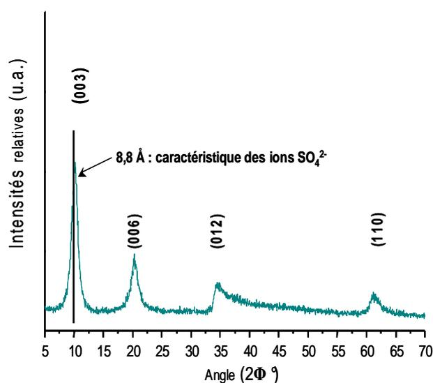
Figure IV-3 : Diffractogramme X de [Zn-Ni-Al-SO<sub>4</sub>]
