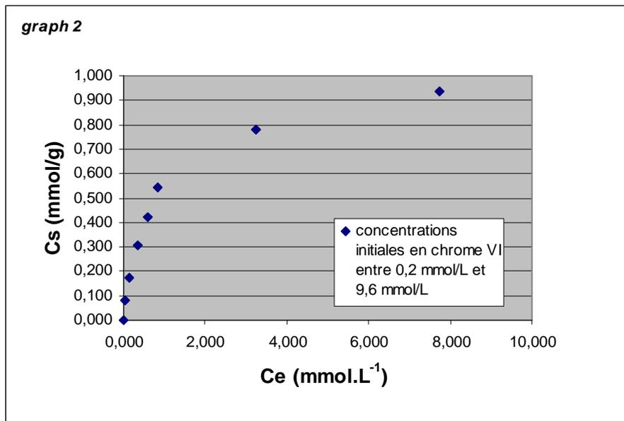
Figure IV-12 : Isothermes d'adsorption de chrome<sup>VI</sup> sous forme chromates sur [Zn-Ni-Cr-SO<sub>4</sub>]
