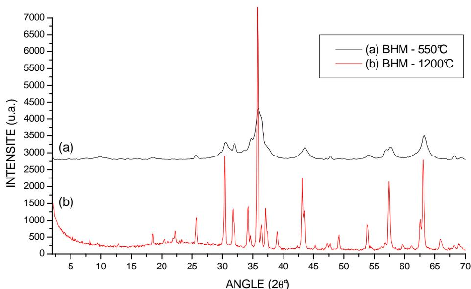
Figure IV-7 : Diffractogramme X d'un échantillon de boue industrielle BHM après un traitement thermique à 550 °C et 1200°C respectivement
