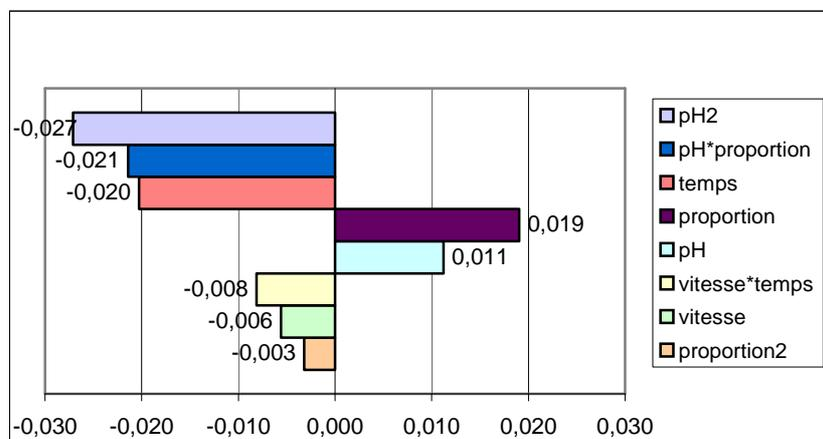
Figure III-18 : Hiérarchisation des effets des différents facteurs opératoires sur le rendement de nickel précipité dans le mélange Ni/Zn
