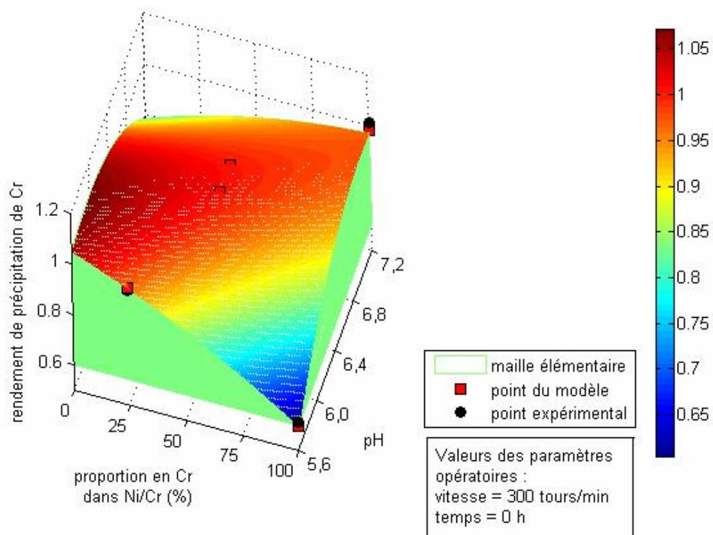
Figure III-14 : Evolution du rendement de précipitation en Cr dans le mélange Ni/Cr, en fonction du pH, la vitesse et le temps étant fixés
