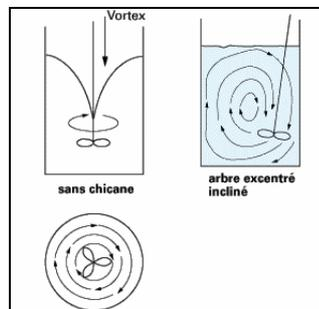
*Figure III-22 : Comportement d'un fluide dans le cas d'un vortex et d'une agitation excentrée inclinée [Roustan M., 2002]*
