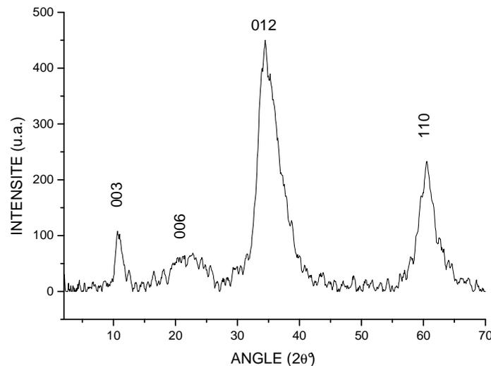
Figure IV-6 : Diffractogramme X d'un échantillon de boue industrielle
