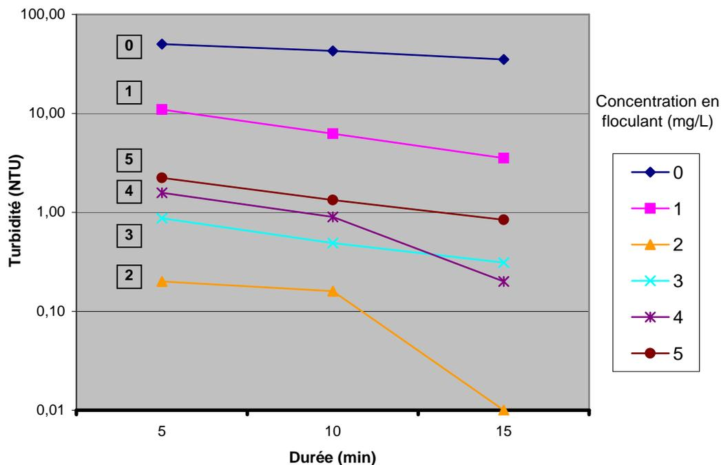
*Figure III-27 : Evolution de la turbidité en fonction de la durée de décantation*
