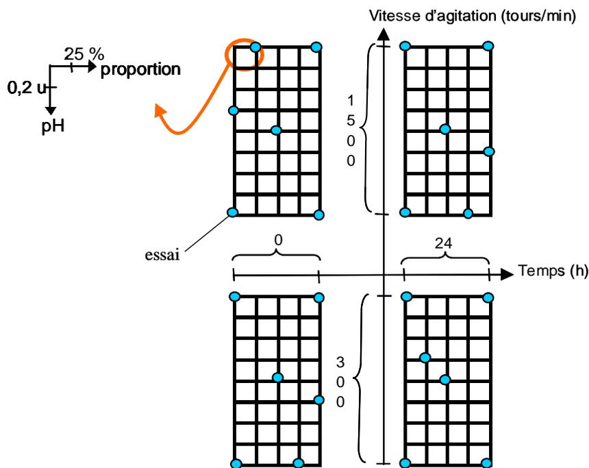
*Figure II-15 : Matrice d'expériences : distribution des essais sur le domaine expérimental*
