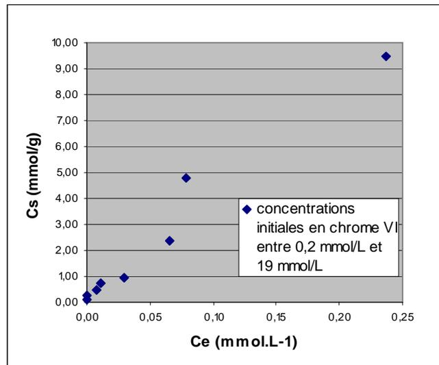
Figure IV-19 : Isotherme d'adsorption de chrome<sup>VI</sup> sous forme chromates sur la boue élaborée en laboratoire
