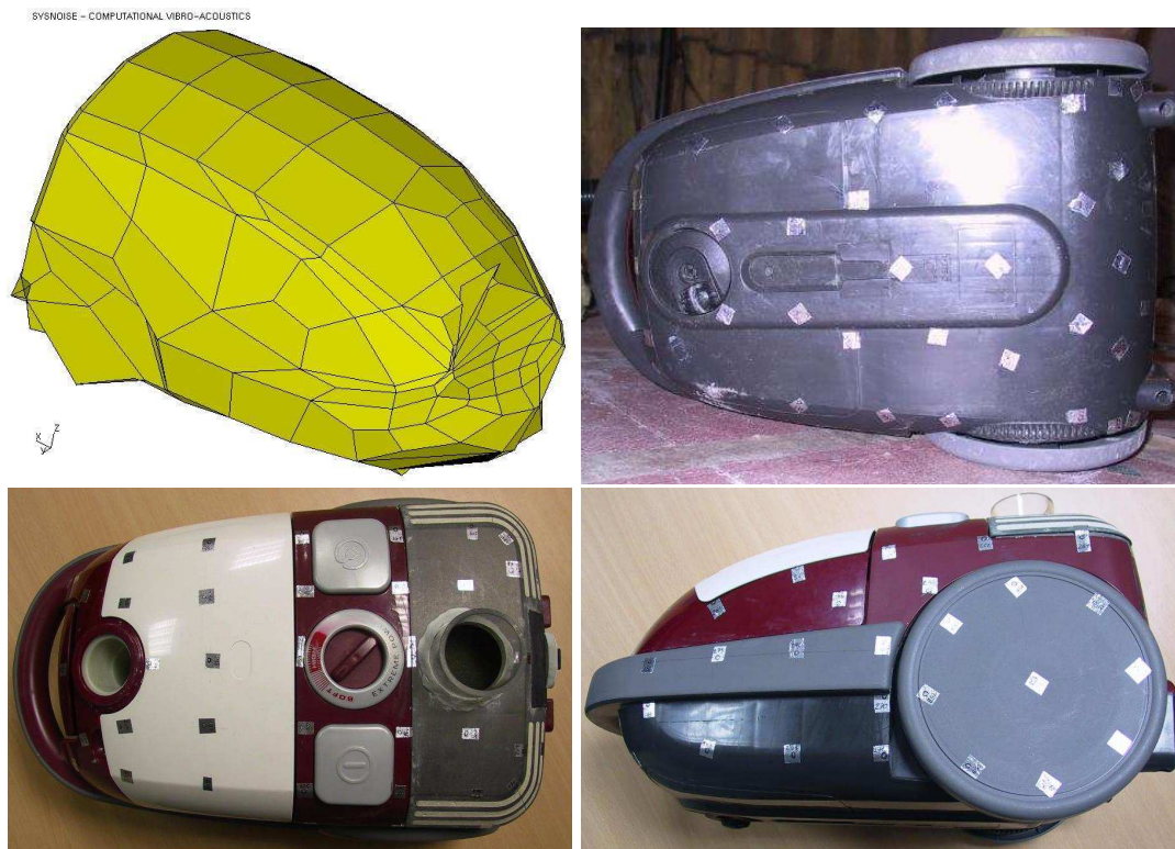
FIG. 4.7 – Maillage Sysnoise réalisé à partir des plans CAO fournis par Rowenta, Vues des points de mesures correspondant aux noeuds du maillage Sysnoise.
