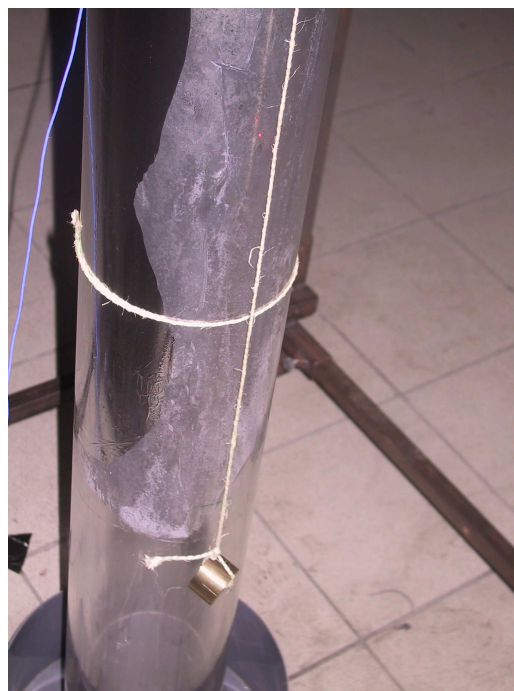
FIG. 6.6 – Réglage de la position et de la visée du laser (fil à plomb)
