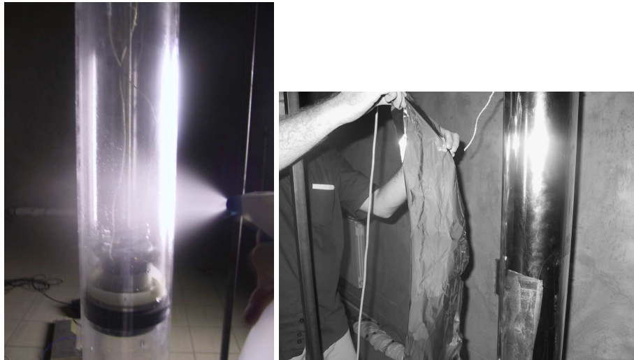
FIG. 6.5 – Humidification du tube et collage du film réfléchissant
