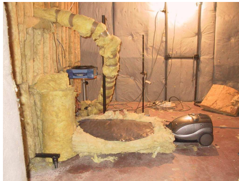
FIG. 4.2 – Mesure de masquage : Corps et évacuation
