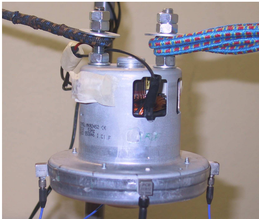
FIG. 6.18 – Moteur suspendu et ses quatre accéléromètres
