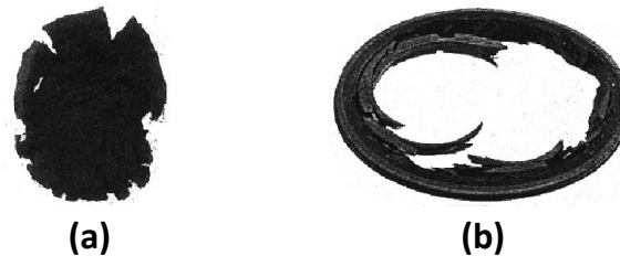
Figure 1.24 : fissures de surface sur (a) un échantillon de polyuréthane cylindrique[77], et (b) sur un joint commercial[78].
