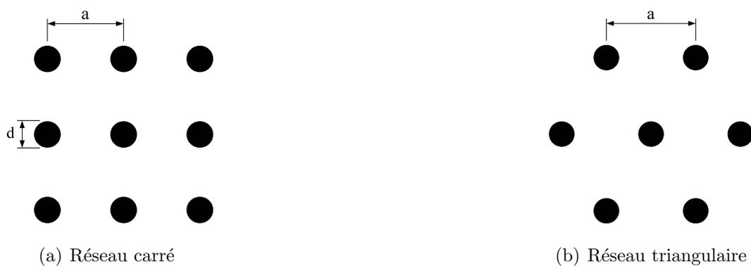
Figure 1.12 – Réseaux classiques des cristaux phononiques à 2 dimensions (a) réseau (à maille) carré et (b) réseau triangulaire.
