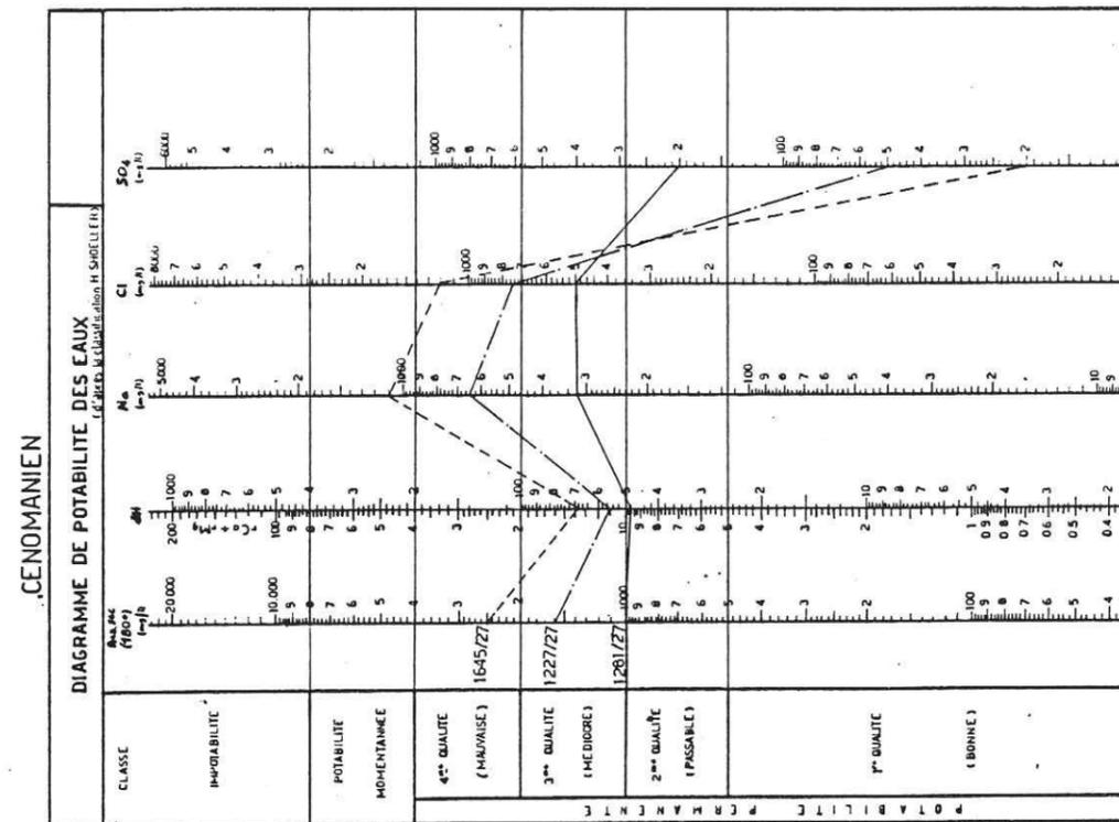
Fig.31b - Diagramme de potabilité des eaux de H. SCHOELLER
