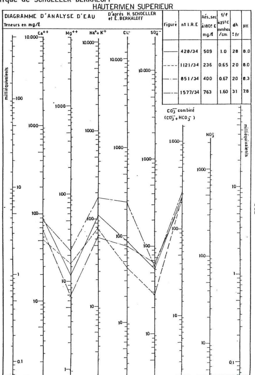
Figure 23d - Diagramme semi-logarithmique de SCHOELLER - BERKALOFF
