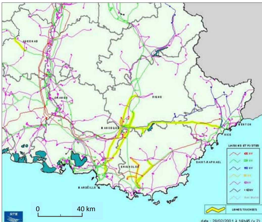
Carte 11 : L'endommagement des réseaux HT et THT par les intempéries de Février 2001, à l'échelle du Grand Sud est de la France. (Source, RTE 2001)
