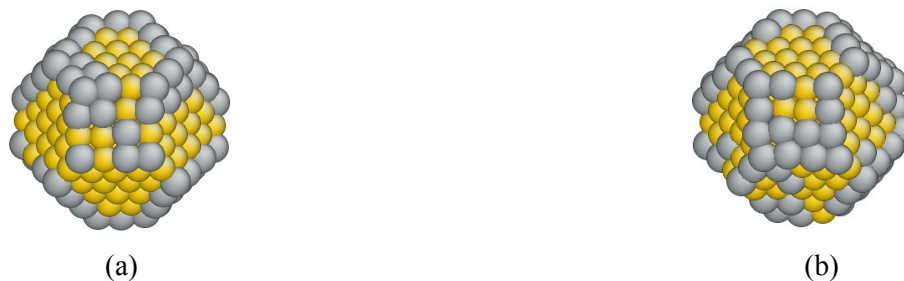
Figure 4.7 Configurations instantanées de la nanoparticule PW_{405} obtenues à T = 300 K par simulations MC avec relaxations dans l'ensemble canonique pour N_{Ag} = 86 (a) et N_{Ag} = 92 (b), montrant le mécanisme de formation de la structure losange des facettes (100). Les atomes de cuivre sont représentés en jaune et ceux d'argent en gris.
