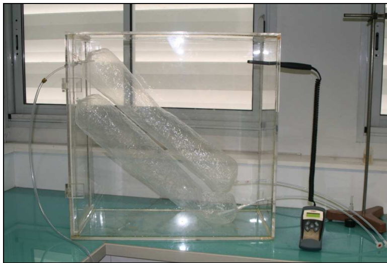
Figure 15. Photographie du caisson contenant deux sacs en Nalophan de 10 L
