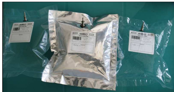
Figure 17. Photographie de sac d'échantillonnage de 3 L en Tedlar, Flexfoil et Teflon (SKC)
