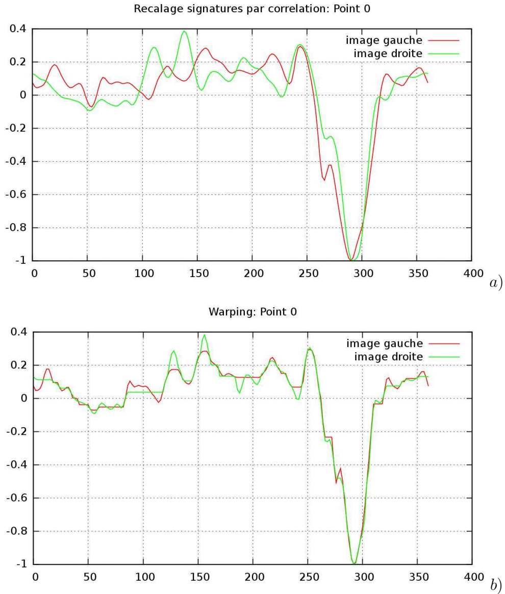
FIGURE 5.9: Résultat de “warping” obtenu sur la séquence “buste”, point 0 (cas plus complexe). a) Signatures après recalage par corrélation. b) Mise en correspondance par DTW contrainte.
