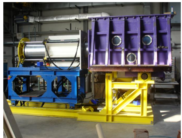
Figure 2-1 : Schéma en coupe et photographie du modèle réduit de tunnelier à pression de terre de l'ENTPE
