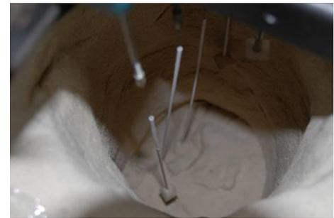
Figure 2-96 : Schéma (a) et photographie vue du dessus (b) du mécanisme de rupture par effondrement du front de taille en massif tricouche.
