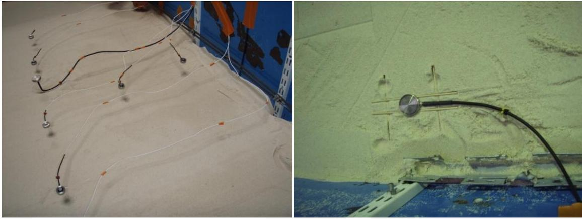
Figure 2-9 : Photographies des différents dispositifs de fixation des capteurs de contraintes.
