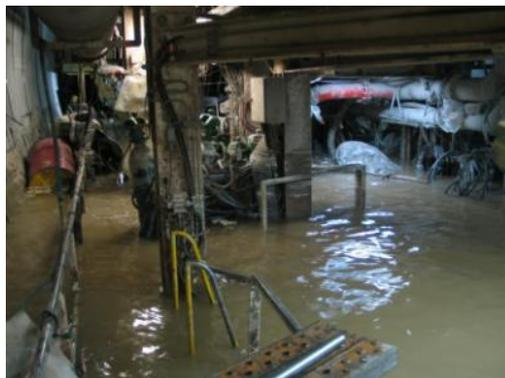
Figure 0-2 : Exemple de tunnelier noyé (Présentation mastère tunnel G. Fontanille, NFM Technologies, 2011).
