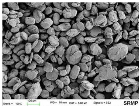
Figure 1.3 : Image de poudre broyée (composition : Fe 18Cr-1W-0.3Ti-0.3Y 2 O 3 (%m)) [23]
