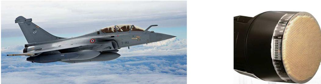
**Figure I.1 Rafale et radar AESA RBE2 (photos Thales)**
