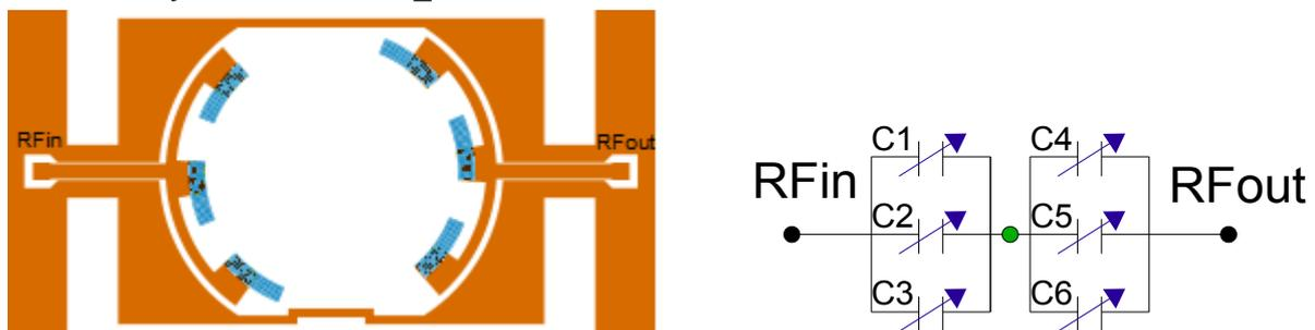
Figure III.21 Motif 6 capacités (RUN1), schéma électrique équivalent
