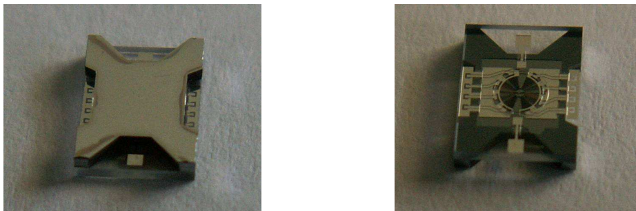
Figure III.50 Puces du RUN2 après découpe, taille 4x5mm
