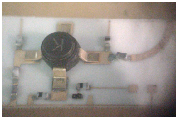
Figure IV.18 Montage du VCO à varactor sur alumine (surface utile 10x20 mm 2 )
