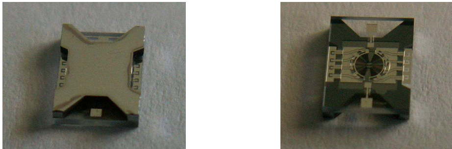
Figure III.50 Puces du RUN2 après découpe, taille 4x5mm
