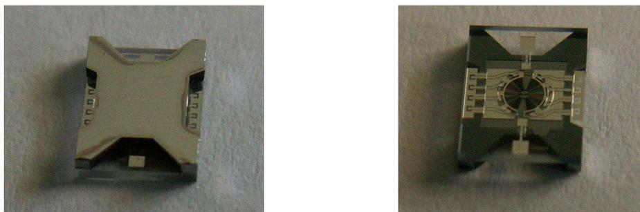
Figure III.50 Puces du RUN2 après découpe, taille 4x5mm
