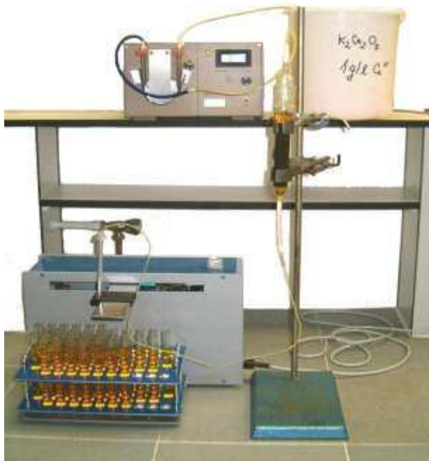
Figure 159 Montage expérimental de la colonne de biosorption
