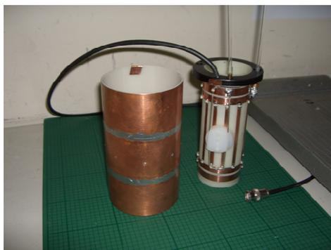
Figure 4-9 : photographie de l'antenne birdcage (à droite) sortie de son écran radiofréquence (à gauche).
