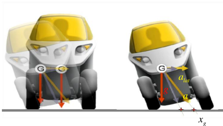
Figure 3. 4 : Accélérations au centre de gravité
