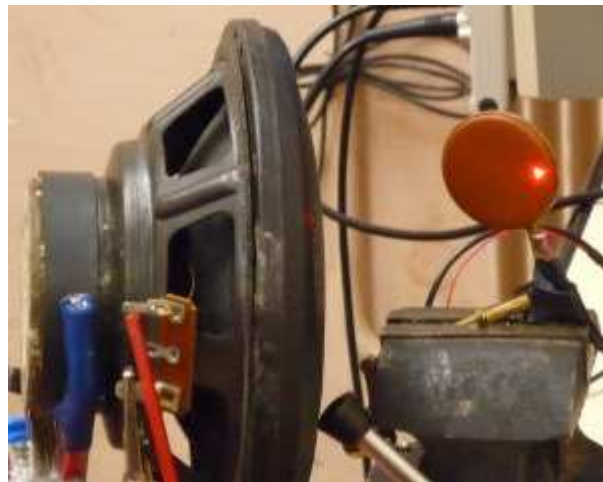
FIGURE 3.12 – Photo de la mesure vibratoire du tampon sans “résonateur”
