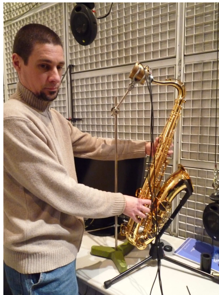
FIGURE F.1 – Montage pour la mesure d’impédance du saxophone.
