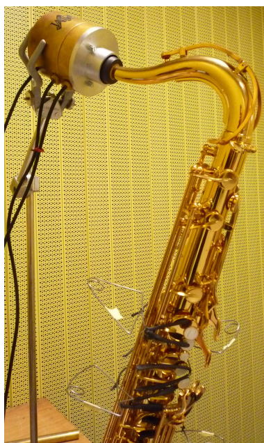
FIGURE 3.19 – Photo de la mesure d’impédance d’entrée du saxophone. Des pinces sont utilisées pour fermer les trous.
