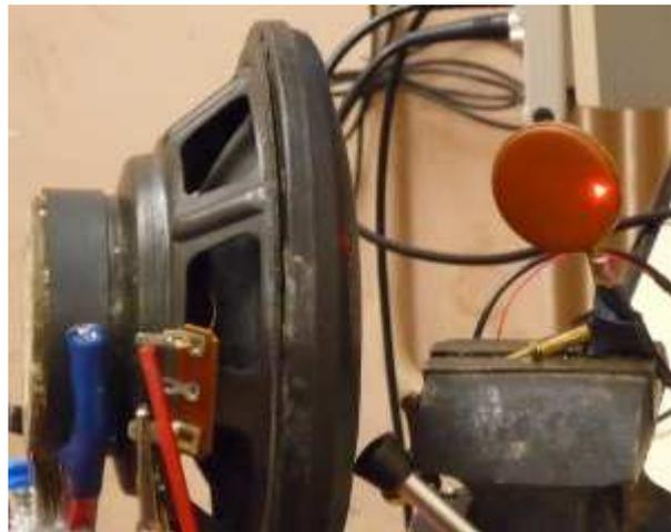
FIGURE 3.12 – Photo de la mesure vibratoire du tampon sans “résonateur”
