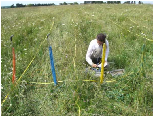
Figure III-28 : Résistivimètre RMCA-4 relié à un jeu de 4 électrodes.
