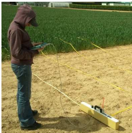
Figure III-29 : CS60 relié à sa console de commande.
