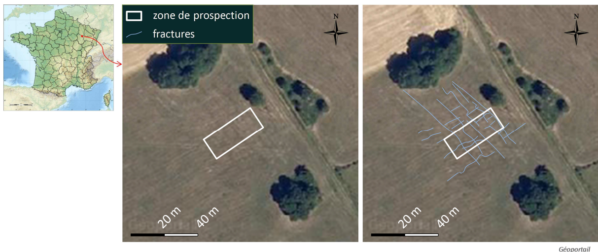
Figure III-52 : Localisation du lieu-dit La Violette (Grand, Vosges) et photo aérienne du site avec interprétation des contrastes observés dans la végétation en terme de fracturation.
