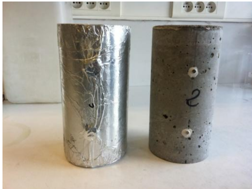
Figure II.10 : isolement du béton par des couches d'aluminium
