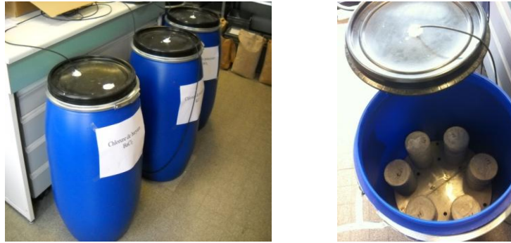
Figure III.3 : dispositifs de conservation sous 91% <HR< 98%
