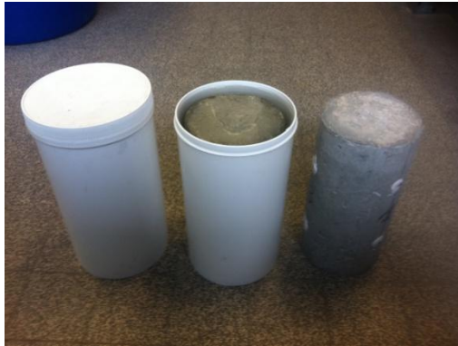
Figure II.9 : conservation des éprouvettes dans l'eau
