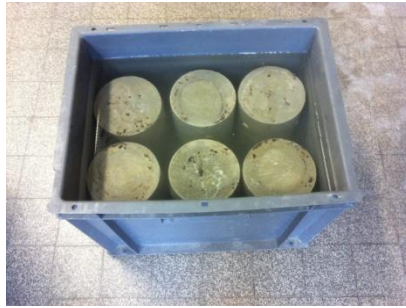
Figure IV.1 : immersion des matériaux dans l'eau
