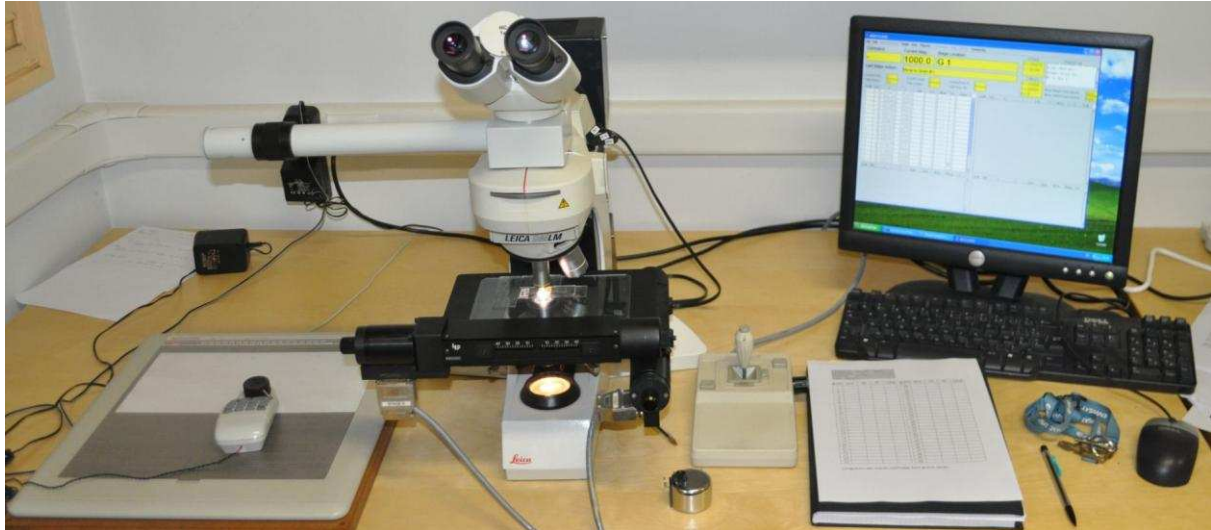
Figure IV.3 - Dispositif de comptage; de gauche à droite : tablette à dessin, souris-pointeur, microscope avec platine motorisée et tube à dessin, joystick de commande de la platine, ordinateur.
