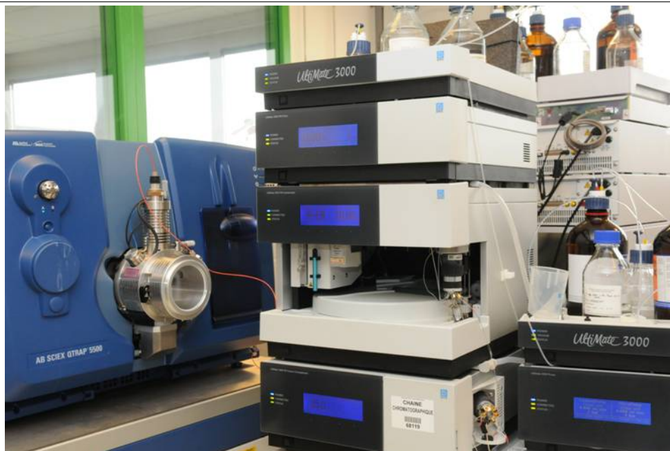
Fig. 3.9 Plateforme protéomique chez l'entreprise bioMérieux à Marcy-l'Étoile : à droite un chromatographe liquide (Dionex, Ultimate 3000), à gauche un spectromètre de masse de type triple quadrupole travaillant en mode SRM (ABSciex 5000QT)
