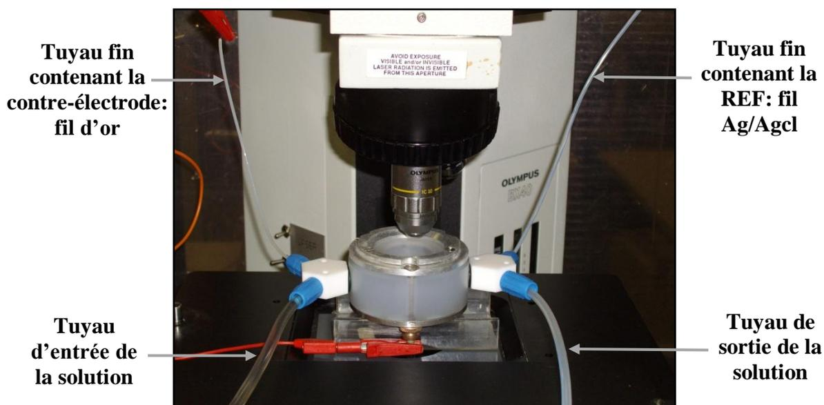
Figure II.2 : Montage avec cellule électrochimique fermée
