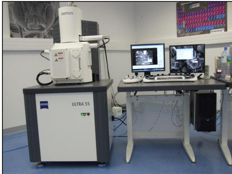
**Figure II.12 : Photo du MEB-FEG couplé à l'EDS**
