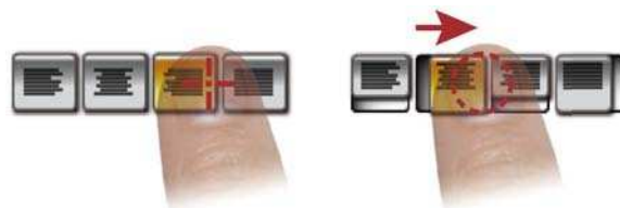
FIGURE 1.15: Widget de sélection proposé par Moscovich [Mos09]. A gauche, sélection imprécise du bouton souhaitée du fait de l'occultation de la zone de contact du doigt. A droite, l'utilisation des widgets proposés permet une sélection précise par l'utilisation de gestes.
