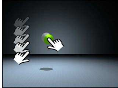
FIGURE 2.11: Z-technique de Martinet et al. Le doigt situé sur l'objet le déplace dans le plan de l'écran, tandis que celui en dehors permet de le déplacer en profondeur via des mouvements verticaux [Mar11].
