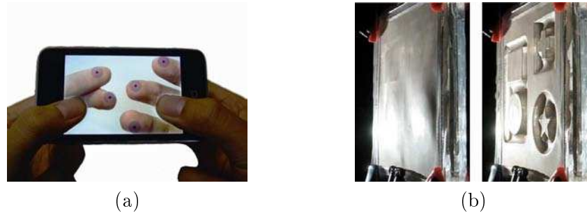
FIGURE 1.9: Systèmes tactiles avec écrans avant et arrière [WLF + 06] (a) et avec boutons physiques [HH09] (b, sans utilisation de pression à gauche et avec à droite).
