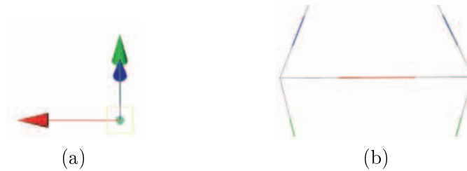
FIGURE 5.4: La sélection de l'axe peut être difficile à effectuer avec un widget standard de translation (a). Un widget cubique permet une sélection plus facile car chaque axe de transformation est représenté par plusieurs arêtes du cube, évitant les problèmes de sélection dus à la superposition de la projection des axes (b).
