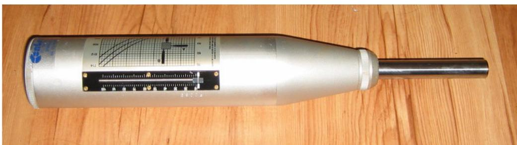
Figure 1 : Scléromètre pour roches
