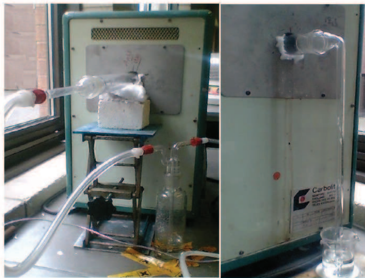
Figure 8 : Photo d'analyseur d'azote [34].
