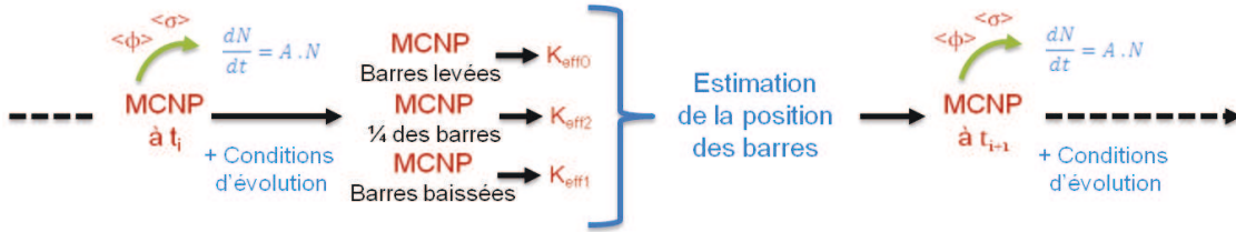
Figure 3.2: Schéma de principe d'une simulation MURE avec gestion des barres de contrôle
