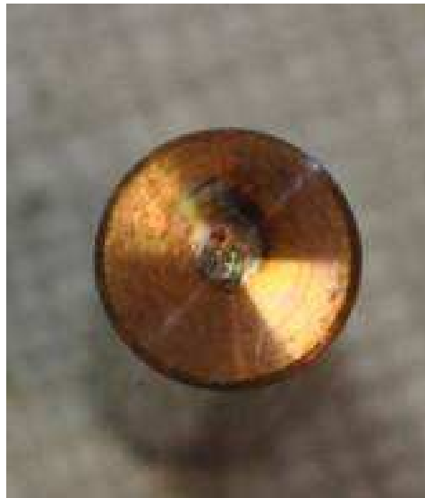
Figure 4.6 : Photographie d'une électrode de cuivre après un arc ( I_{arc} = 91 A, dt = 8 ms) dans l'air à pression atmosphérique.
