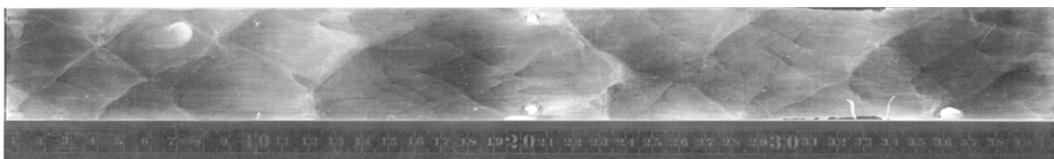
Fig. 5. 16 – Structure cellulaire multitêtes du mélange isooctane/(O<sub>2</sub>+2N<sub>2</sub>) à richesse 0,6
