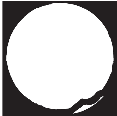
(d) Remplissage des fissures internes par n_1 dilations successives suivies de n_1 érosions ( n_1 = 10 )
