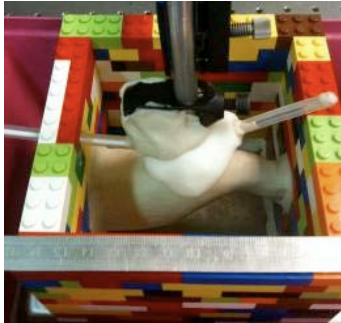
Figure 2.26. Disposition des différents éléments anatomiques dans l'enceinte de moulage : le rectum en plastiline (partie inférieure), la prostate à laquelle est fixée la sonde urétrale (partie moyenne) et le bras de levier collé à la prostate par de la plastiline pour maintenir la glande à distance du rectum.
