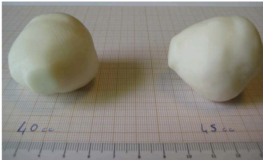
Figure 2.24: Prototypage de prostate de 40 et 45cm 3
